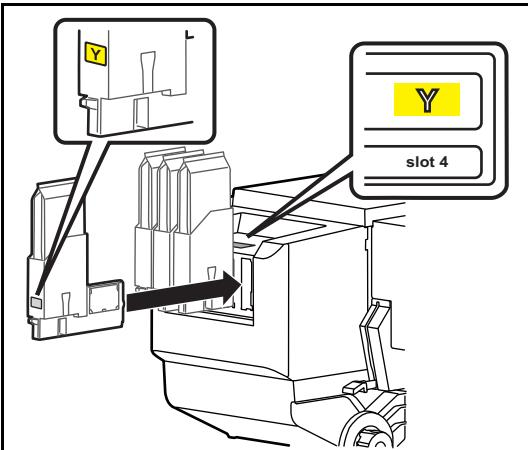
大容量パックアダプターを元のカートリッジスロットに取り付けます。
