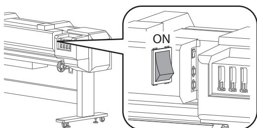
製品背面のプロアヒーターの電源をオンにします。
