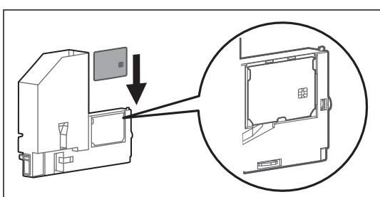
[3] 大容量パックアダプターのロックレバーを下げながら、インクパックを挿入します。
