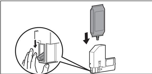
大容量パックアダプターのロックレバーを下げながら、インクパックを挿入します。
