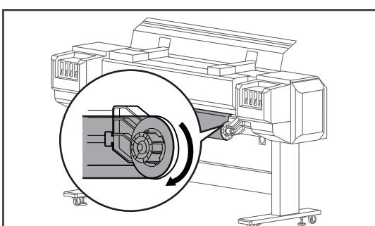
メディア先端を押さえながら、ロール紙受けのフランジを回してロール紙を少し巻き戻し、メディアのたわみおよび斜行を取り除きます。
