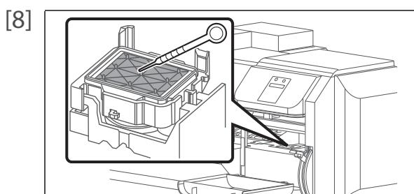
スポットを使用して、汚れていないメンテナンス液をキャップ吸収材全体に垂らします。
