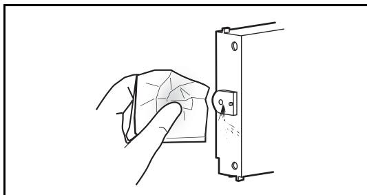
プリンター付属のペーパータオルで、インクカートリッジの差し込み口に付着しているインクを拭き取ります。
