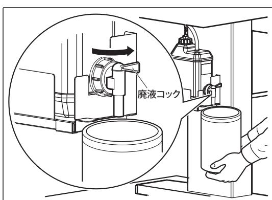
[6] 廃液を空容器に移し終わったら、廃液コックを確実に閉めます。
