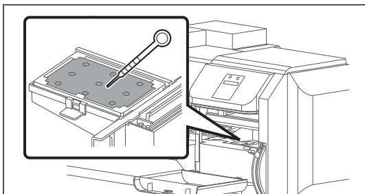
スポットを使用して、メンテナンス液をフラッシングボックス用吸収材全体に垂らします。
