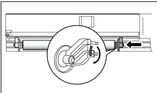
ロール紙受け（右）をロール紙に取り付け、固定レバーを締め付けます。
