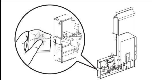
プリンター付属のペーパータオルで、大容量パックアダプターの差し込み口に付着しているインクを拭き取ります。
