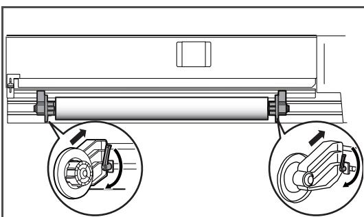
ロール紙受けをプリンター側に押しつけながら、固定レバーを締め付けます。
