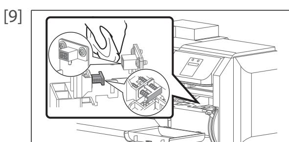
ペーパータオルをメンテナンス液数滴で湿らせ、エアバルブに付着したインクを完全に拭き取ります。
