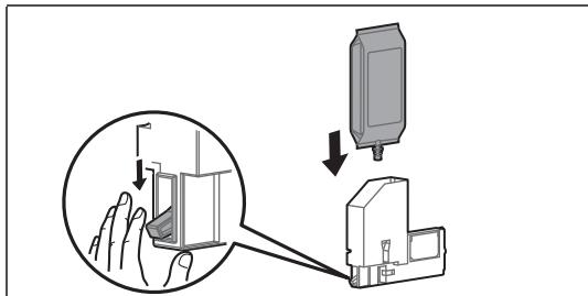
大容量パックアダプターのロックレバーを下げながら、洗浄液パックを挿入します。
