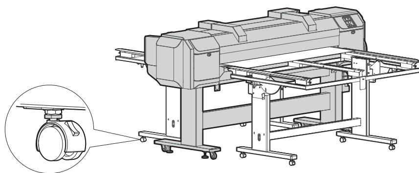
[9] 調整後、搬送台のキャスター（4箇所）の六角ナットを、搬送台のテーブルに向かってスパナで締めます。
