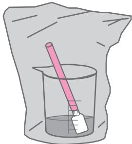
清掃後、クリーンスティックはメンテナンス液に浸して保管してください。
