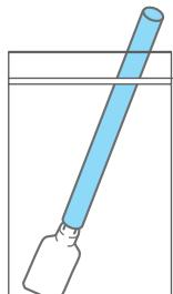
清掃後、フラッシングボックス用吸収材を清掃したクリーンスティックは、チャック付き袋に入れて保管してください。
