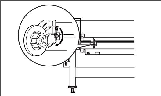
ロール紙受け（左）の固定レバーを締め付け、ロール紙受け（左）を固定します。
