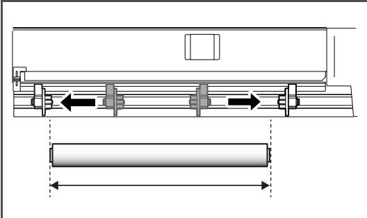
左右のロール紙受けの間隔を、セットするロール紙幅より大きく広げます。
