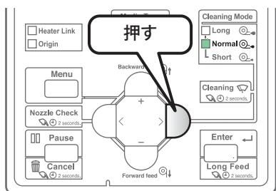
[Cleaning] キーを押して、[Cleaning Mode] ランプが [Normal] に点灯しているようにします。
