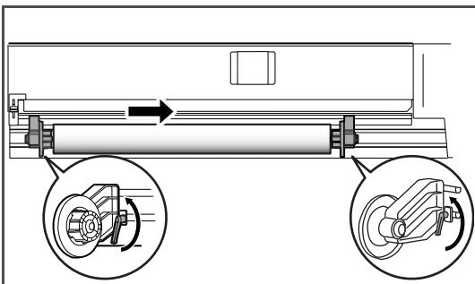
ロール紙受け（左、右）の固定レバーを緩め、ロール紙を製品中央に移動させます。
