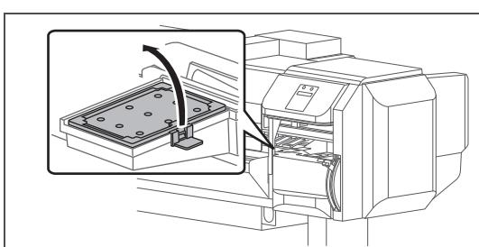
フラッシングボックス用吸収材のツメ部を持ち上げてフックを解除し、
